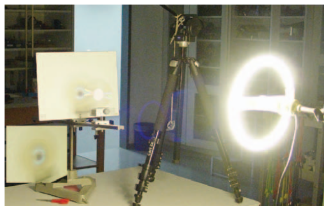
Abb. 2. Die CD erzeugt ein kopfstehendes seitenverkehrtes Bild einer Ringleuchte. Der Ausschnitt zeigt das Bild noch deutlicher.
