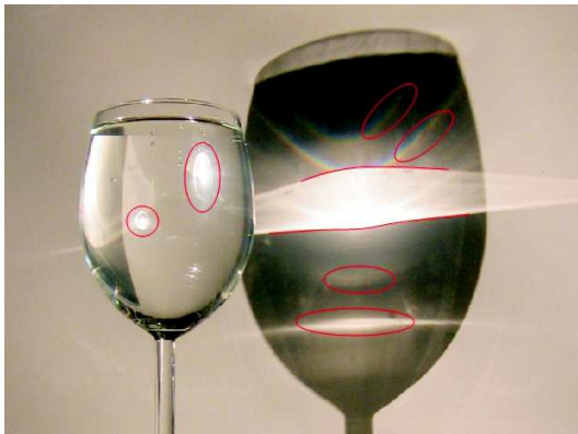
Abbildung 8: Spiegelung, Brechung, Dispersion und reelle und virtuelle Bilder beim Weißweinglas
