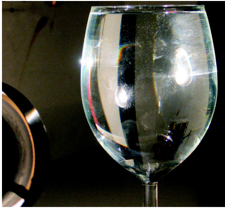
Abbildung 6: Reelle und virtuelle Abbildungen der Lichtquelle
