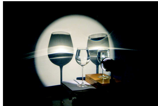
Abbildung 11: Der Farbstreifen tritt nicht bei allen Gläsern auf: Er ist eine Folge der Glaswand.
